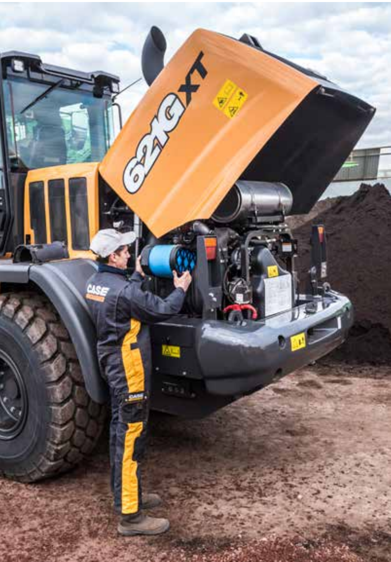
Der von drei Seiten zugängliche Motor erleichtert die Wartung.
