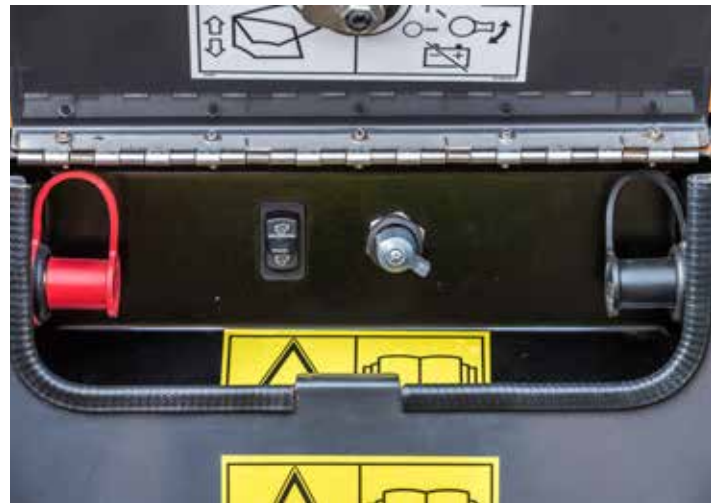
Elektrisch öffnende Motorhaube und Batterie-Hauptschalter. Anschlüsse für den Fremdstart.
