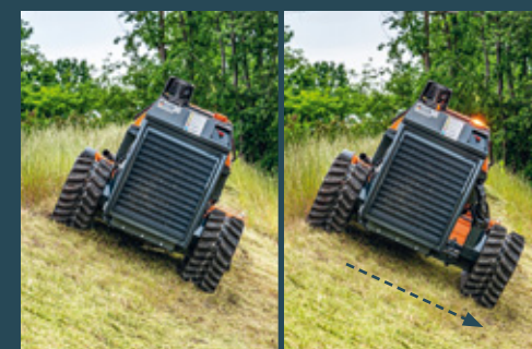
Beidseitig ausfahrbares Raupenfahrwerk mit Bergmann Anti Drift Control für mehr Stabilität.
